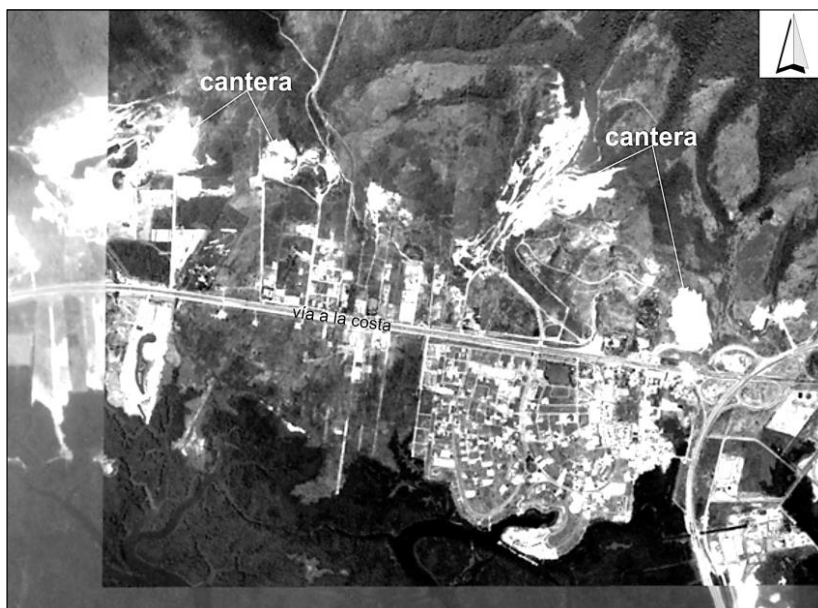
Fig. 1. Foto aérea del IGM al año 1992. Las zonas blancas evidencian la presencia de canteras previo al desarrollo urbanístico de la zona.
