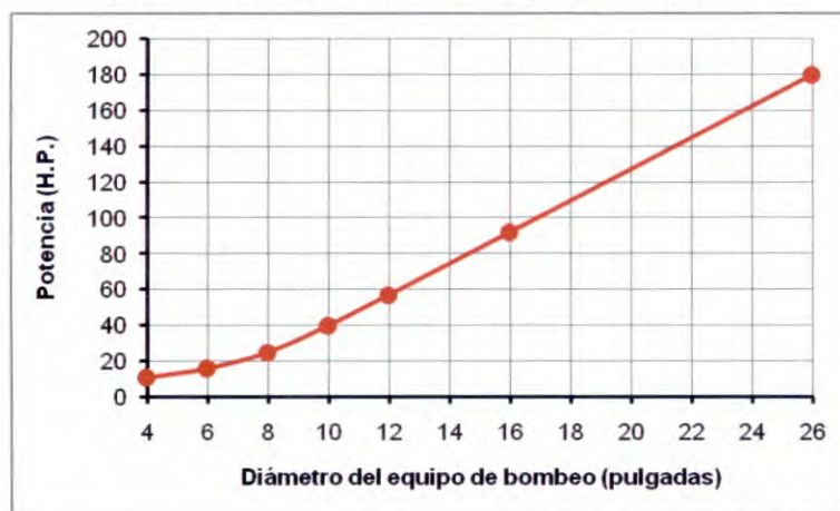
GRÁFICO N° 1: Diámetro del equipo de bombeo
