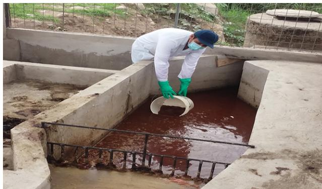
Muestreo de agua residual de camal municipal de Santo Domingo para aislamiento de bacterias degradadoras de materia orgánica. Mini-planta de biofiltración de efluentes del camal municipal.
