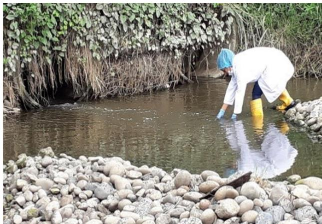
Muestreo de agua contaminada cerca de Refinería Esmeraldas para aislamiento de bacterias degradadoras de hidrocarburos.
