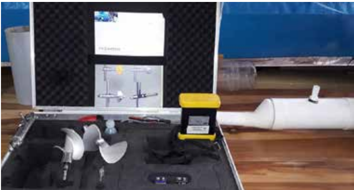
Este es el Correntómetro junto con los tubos extensores el cuál es un instrumento para medir la velocidad de corrientes en el mar, en los ríos, arroyos, estuarios, puertos y modelos físicos en laboratorio.
