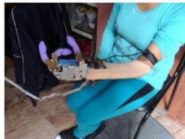
Mano robótica Activada por señales Electromiográficas. UPS (2012)
