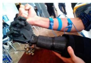
Prótesis Robótica controlada por señales mioeléctricas. UTPL (2014)
