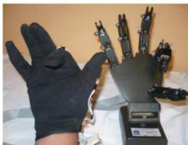
Mano Robótica controlada mediante guante sensorizado. EPN (2009)
